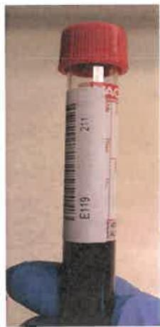
Obr.4 Chybně nalepený štítek
